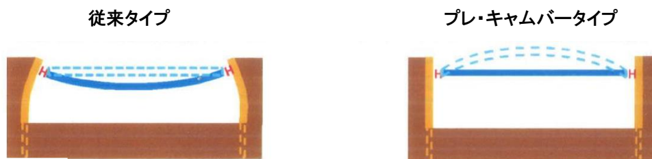
図1.長支間切梁架設時変位の概略図
