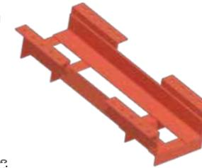
フランジ補強金物・ウェブ補助金物
