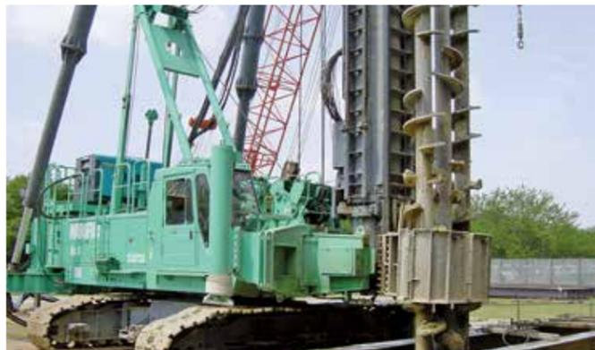
SMW工法(Soil Mixing Wall)は原位置土とセメント・ベントナイト混合液を削孔～注入～混練し、応力材としてH形鋼を挿入して連続した柱列壁を造成する工法です。
