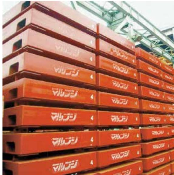
当社の覆工板は、地下鉄工事をはじめ、地下街の建設・地下配管工事など各種路面掘削工事のほか、仮設構台・栈橋用床板として広くご利用いただいております。
