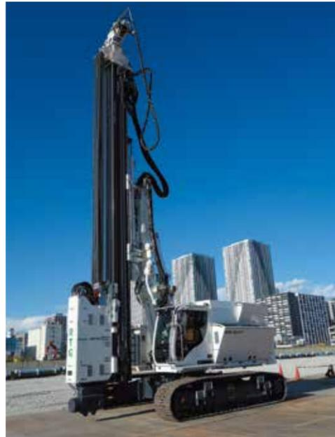
RG杭打機はドイツパワー社の製造による伸縮型リーダーを有する油圧可変式超高周波パイプロ杭打機です。本体機リーダーに装着される油圧可変式超高周波パイプロは大きな貫入力を有しており、起振力を調整することで、地層に合わせた施工が可能です。また、油圧可変式パイプロの為、振動開始および停止時に発生する有害な共振を避け、瞬時に高周波領域へ移ることができます。パイプロ併用の圧入により、削孔時のセメントミルク注入が不要で残土も発生しない為、環境負荷の低減がはかれます。また、装備される伸縮型リーダーは、自動垂直制御により、高い精度管理を可能とします。施工効率が高い為、工程・コスト面で非常に優れた機械となります。
